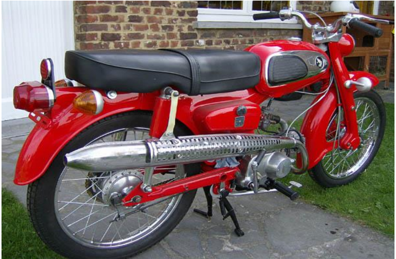
Honda Sport S50 với cỗ máy OHC mới, 49cc 5,8 mã lực, hộp số 3 số chân, tốc độ 80 Km/giờ.
