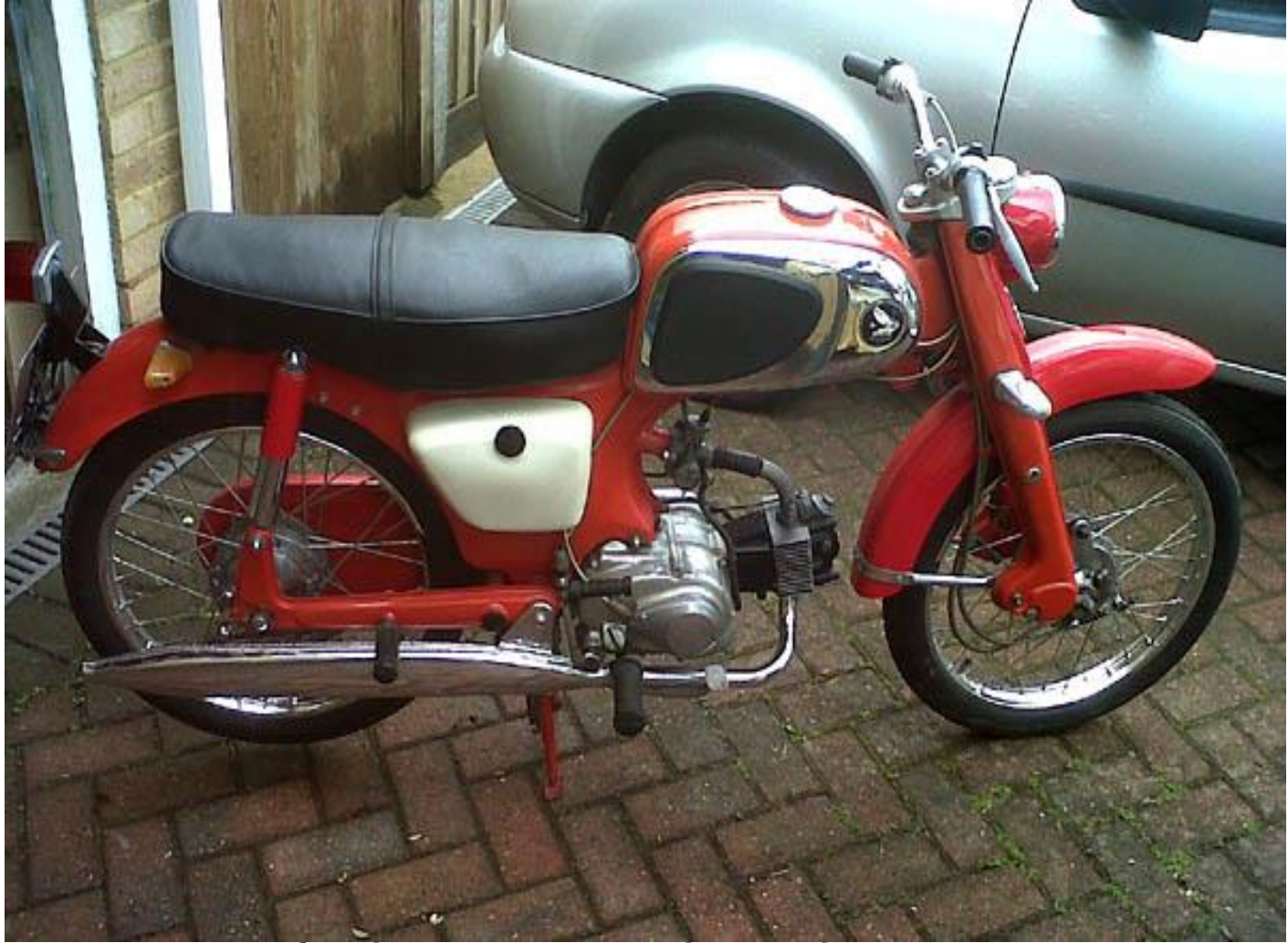
Honda C114, một kiểu biến cải từ xe C110 với ống pô thấp
