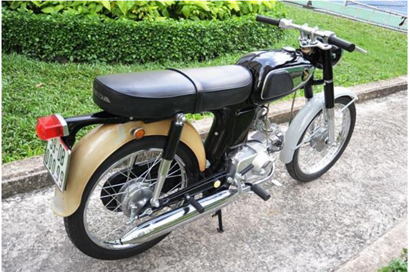
Những kiểu xe Honda SS50 đầu tiên tại Việt Nam (SS50E ở Châu Âu), động cơ 4 thì OHC, 6 mã lực, hộp số gồm 5 số chân, tốc độ 85 Km/giờ
