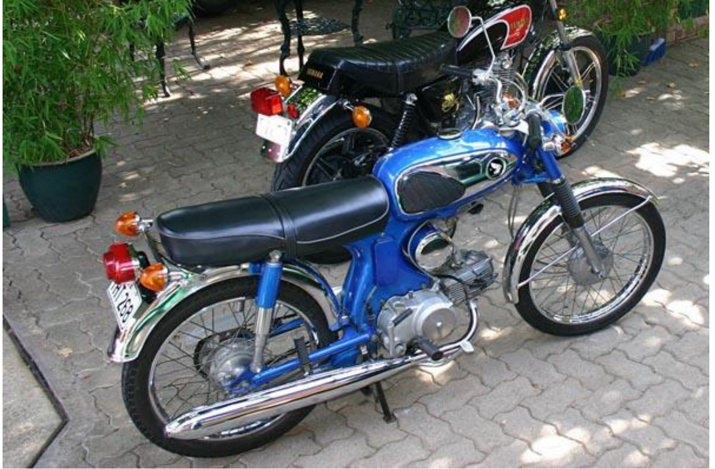
Một xe Honda Sport S90, động cơ 89,6 cc, 4 thì OHC, hộp số 4 số chân, tốc độ 110 Km/giờ
